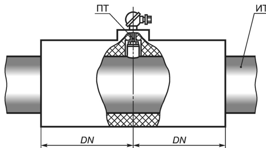
Рисунок 1 — Примеры теплоизоляции корпуса участков ИТ и ПТ
