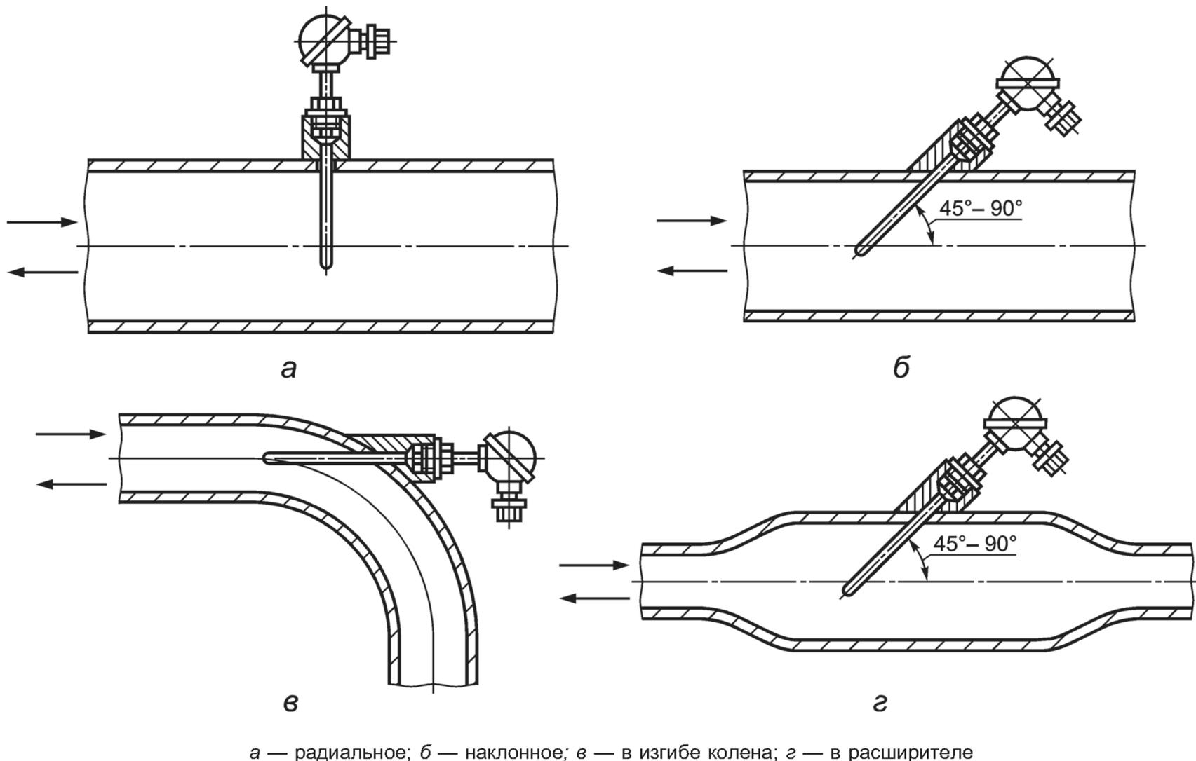
Рисунок 2 — Схема расположения чувствительного элемента преобразователя температуры
