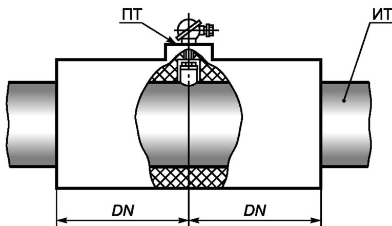
Рисунок 5 — Пример теплоизоляции участков ИТ и ПТ
