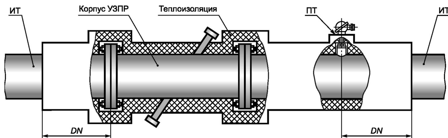
Рисунок 6 — Пример теплоизоляции корпуса УЗПР и участков ИТ
