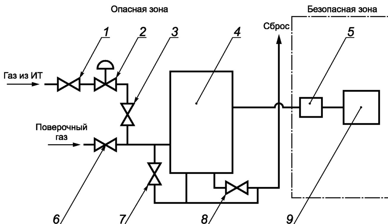
1 – изолирующий клапан; 2 – регулятор давления; 3, 6, 7, 8 – клапаны; 4 – плотномер; 5 – барьер искрозащитный;
